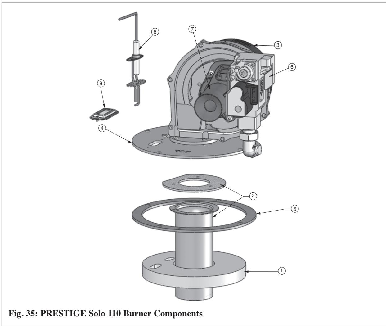
**Fig. 35: PRESTIGE Solo 110 Burner Components**
